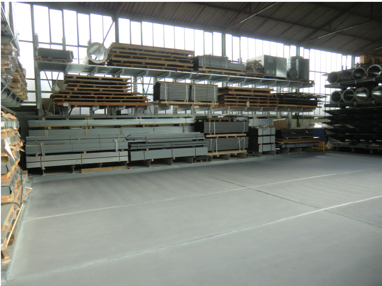
NACHER: Neue Schwerlastregale als einseitige Kragarmregale an den Hallenwänden
