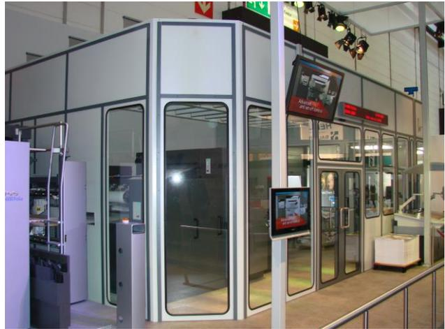
Als **einziger Schallschutzanbieter** konnten wir dieses Jahr zum dritten mal in Serie unsere Leistungsfähigkeit mit einer Schallschutzeinhausung an der produzierenden Maschine demonstrieren. Am Stand von GOSS haben wir den Plano der neuen **M 600 Folia** mit einer Schallschutzeinhausung umgeben.
